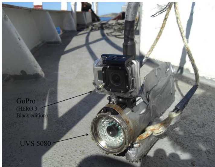
Figur 3. Undervannskamera benyttet til videundersøkelser i Nordland.
